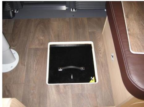
Deckel des Bodenstaufaches entfernen und Tresor probe-weise im Staufach platzieren. Dabei auf den leichten Zugang zum Schloss achten. Anschließend den Safe wieder herausnehmen.
