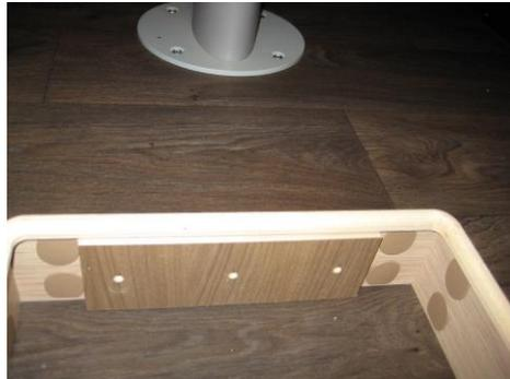
Die Distanzbretter rechts und links zur Fahrtrichtung im Bodenstauraufach mit jeweils drei Senkkopfschrauben 4x25 mm befestigen. Die Seite mit dem Filzstreifen zur Bodenplatte hin befestigen, um Knarrgeräusche zu vermeiden.
